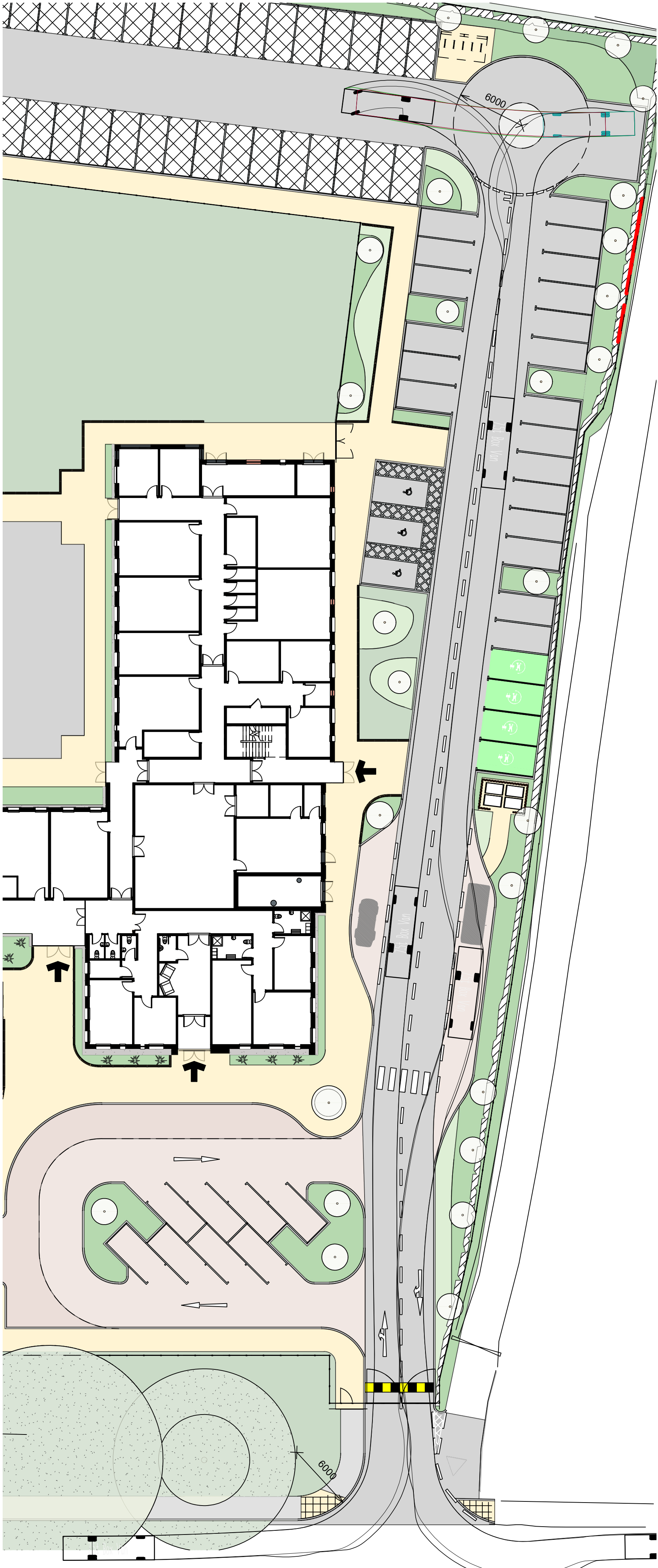
7.5t Box Van - Layby and Turning Head
